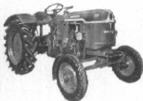
Tractor met grote banden 10-28, lange wielbasis derhalve grote trekkracht en geen steigeren, lage bouw wijze, grote bodemvrijheid, gunstig zwaartepunt.
